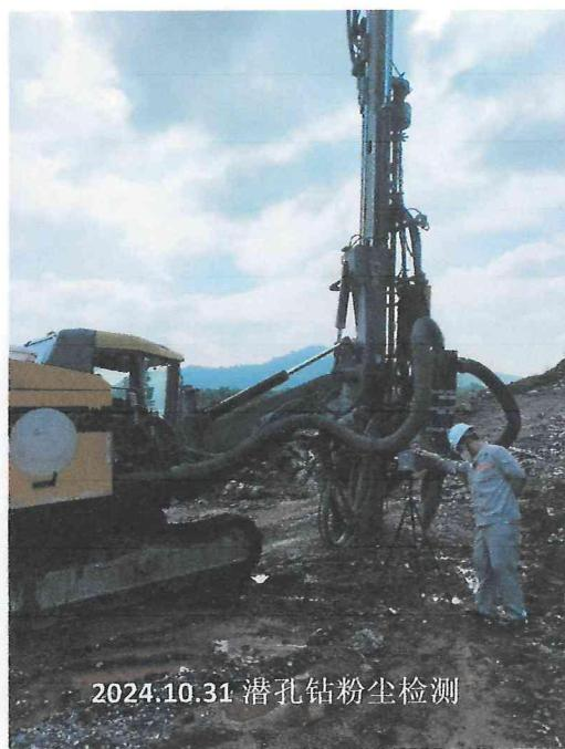
2024.10.31 潜孔钻粉尘检测
