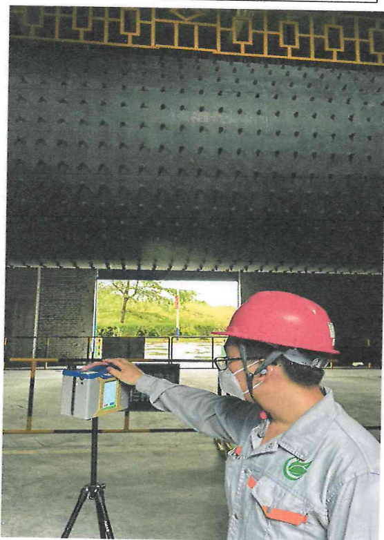
检测日期：2024.9.1 水泥磨粉尘采样
