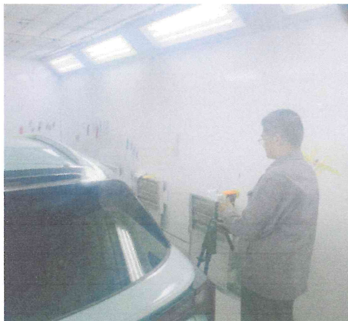
烤漆房采样照片
